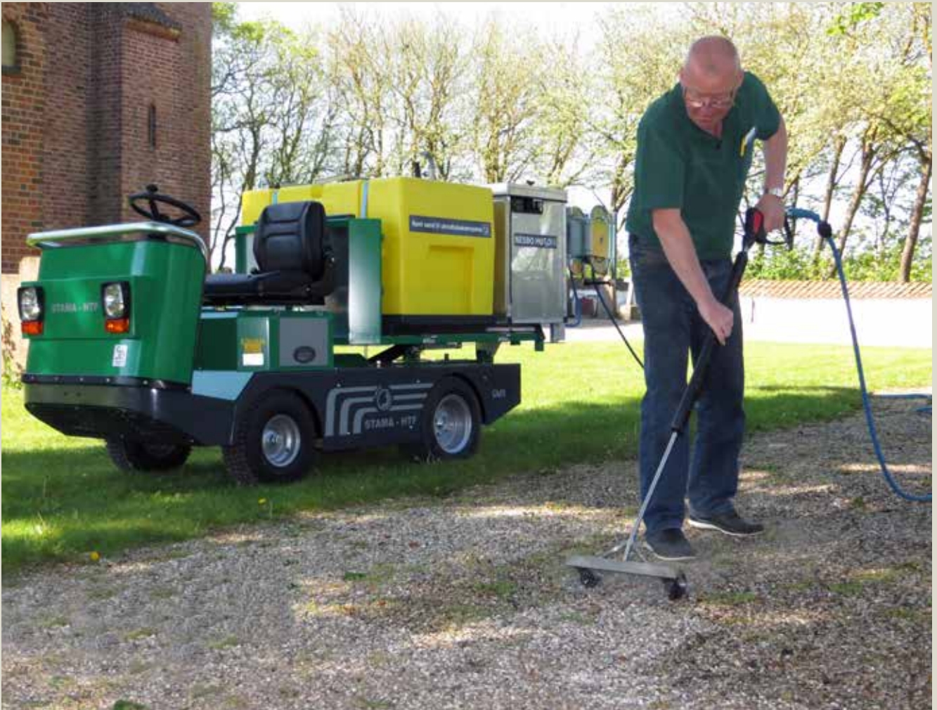
Med HOT2O-anlægget kan ukrudt bekæmpes med 98 grader varmt vand. Foto fra GMR Maskiner A/S.
